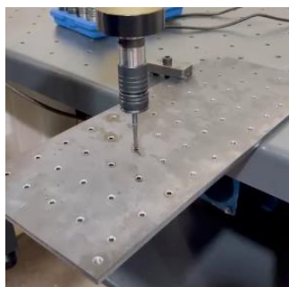
Figura 3. Placa base já cortada e em processo de rosqueamento dos furos. Fonte: Autores.
